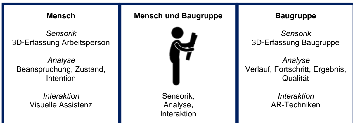
Abbildung 1: Systemarchitektur 3D-Montageassistent (mod. nach Stüring 2016)
