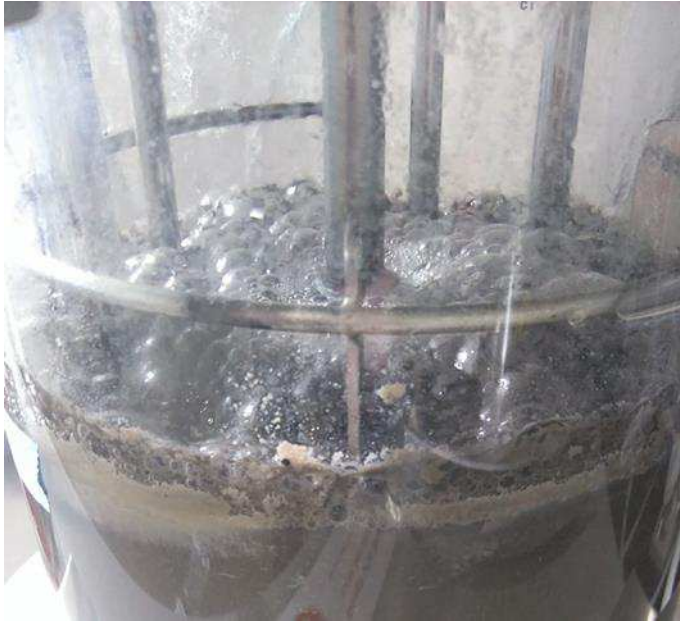
Abbildung 24: Schaumbildung nach Versäuerung in Unit 1.
