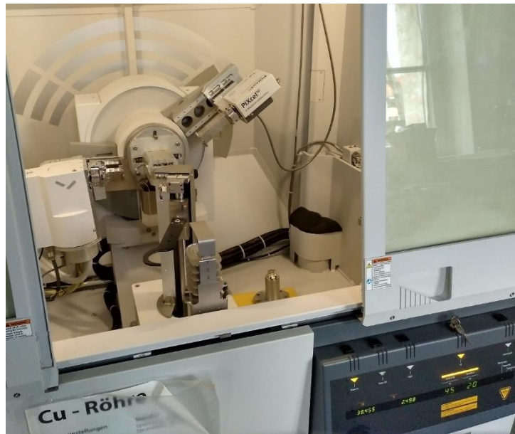
Abbildung 5 Panalytical X'PERT 3 Powder Röntgendiffraktometer an welchem die Messungen an Allanit-(Ce) durchgeführt wurden.
