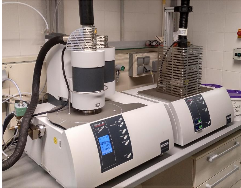
Abbildung 3 Netzsch STA 449 F3 Gerät an welchem die Dynamische Differenzkalorimetrie mit gekoppelter Thermogravimetrie (linkes Gerät) durchgeführt wurde, sowie QMS 403D Aeolos Netzsch Massenspektrometer (rechtes Gerät).
