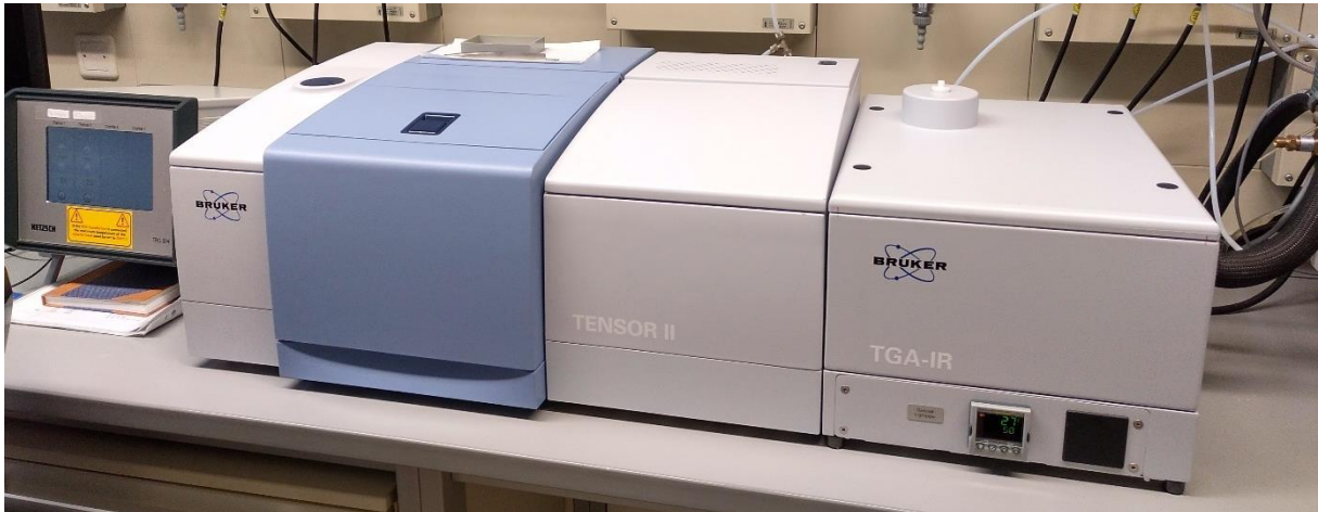
Abbildung 9 Bruker Tensor II TGA-IR Spektrometer an welchem Transmissions-Infrarotspektroskopie durchgeführt wurde.
