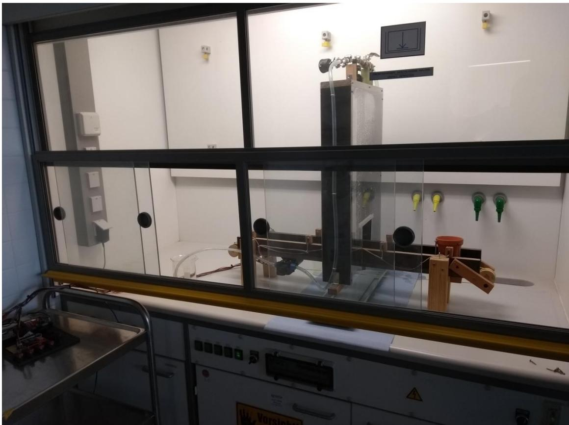
**Abbildung 2: Spritzapparat im Abzug**
