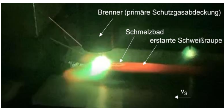
Bild 27: Links: Aufnahme des Nachglühens beim Stegsschweißen. Rechts: Verwendung einer Schleppgasdüse mit Ar 4.6 als Schutzgas
