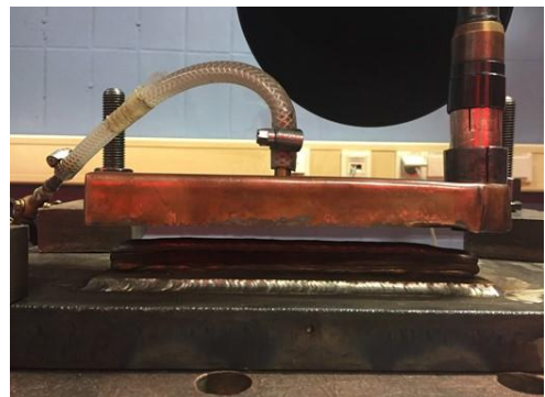
Bild 27: Links: Aufnahme des Nachglühens beim Stegsschweißen. Rechts: Verwendung einer Schleppgasdüse mit Ar 4.6 als Schutzgas
