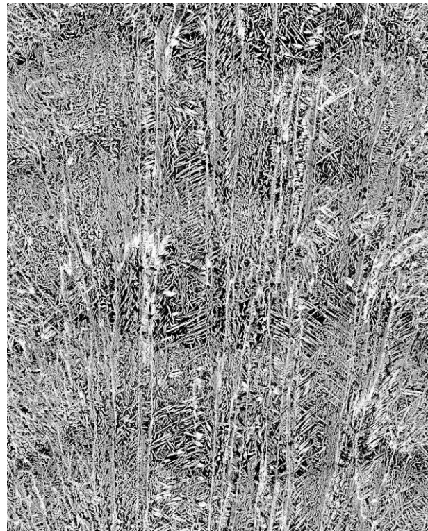
aus Panorama erzeugtes Binärbild 43 % Ferrit
