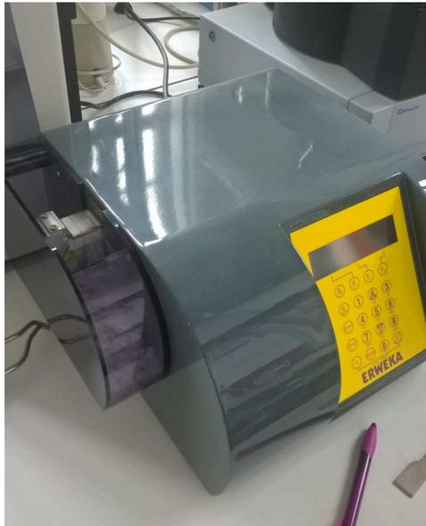
Abbildung 33: ERWEKA 225D Tabletten-Bruchfestigkeit-Tester
