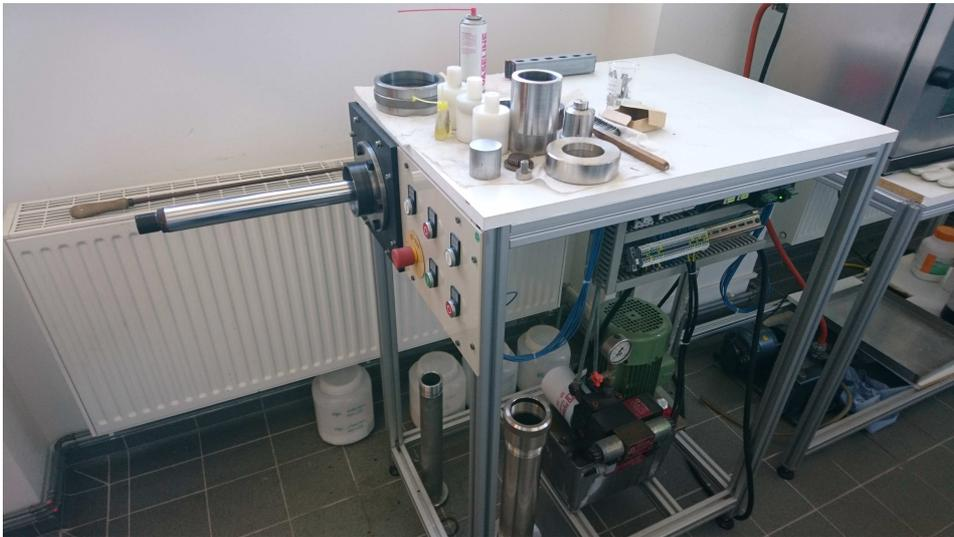
Abbildung 28: Der verwendete Extruder
