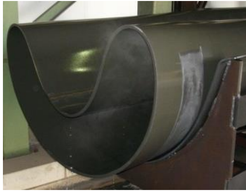
Abbildung 1: Eingefallenes Rohr nach der Wärmenachbehandlung [12]
