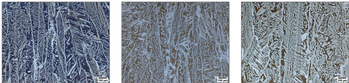
a) UP-Eindraht b) UP-Eindraht mit Kaltdraht c) UP-Doppeldraht mit Kaltdraht Abbildung 37: Mikroschliffbilder der Schweißverbindungen an der Legierung 1.4410, aufgenommen in der Decklage, Ätzung: Beraha II
