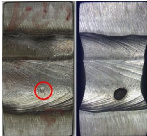
Abbildung 2: UP-Schweißprobe vor und nach dem Korrosionstest (ASTM G48-A, 50°C)
