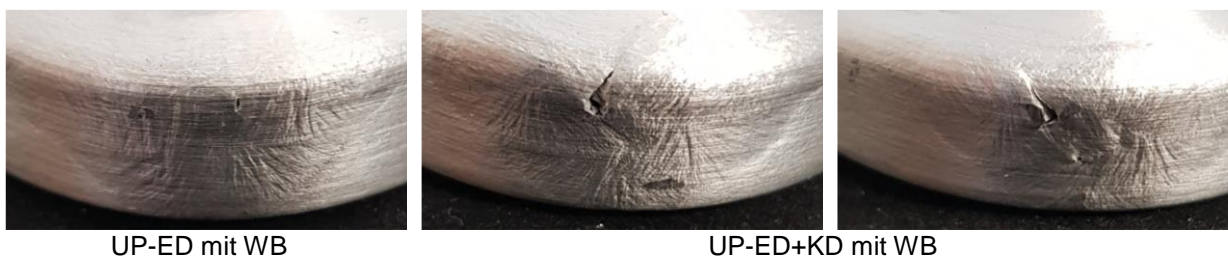
Abbildung 55: Aufnahmen von Proben mit Rissen nach der Biegeprüfung, UP-ED-Schweißung mit WB (links) und UP-ED+KD-Schweißung mit WB (mitte und rechts)
