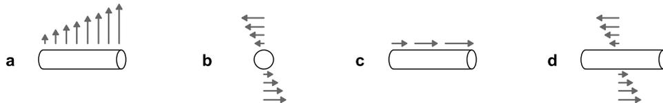
Abbildung 9 Die vier auf die Fasern wirkenden Lastfälle während des Plastifizierens in einer Plastifiziereinheit bzw. einem Extruder (Thieltges 1991).
