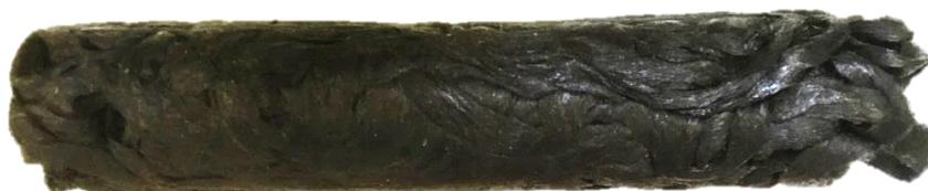
Abbildung 29 Fehlerbild 3: *Unvollständige Ausformung*
