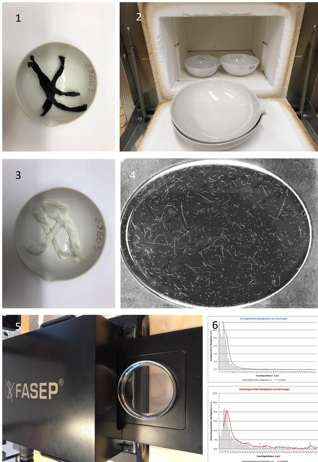
Abbildung 91 Die sechs Schritte der Faserlängenanalyse: 1) Materialproben im Tiegel 2) Pyrolyseofen mit Tiegeln 3) Veraschte Proben mit übrigen Glasfasergerüst 4) Petrischale mit in Lösung gegebenen Glasfasern 5) Scanner mit Petrischale für automatisierte Faserlängenanalyse mittels Graustufenerkennung 6) Histogramme als Ergebnis der Anzahl- und gewichtsgemittelte Faserlängenanalyse
