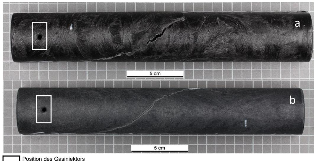
Abbildung 54 Rissverlauf nach Torsionsprüfung an zwei Versuchsbauteilen aus pultrudiertem Material mit 30 Gew.-% GF, gefertigt im GasComp-Prozess (a) und GAIM-Prozess (b) jeweils in Kombination mit dem Nebenkavitätsverfahren.
