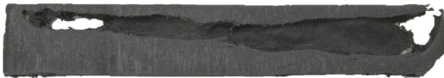
Abbildung 28 Fehlerbild 2: *Gasblasendurchbruch*
