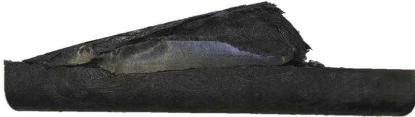
Abbildung 27 Fehlerbild 1: *Aufgeplatzter Träger*
