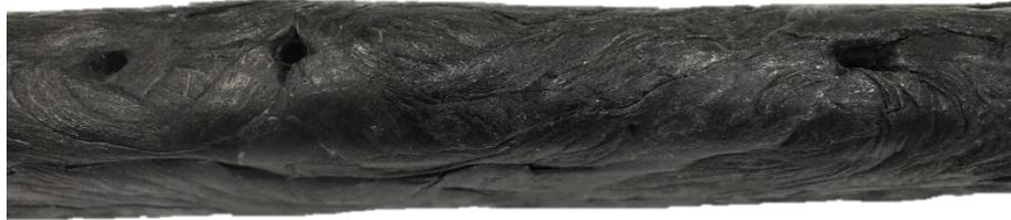
Abbildung 30 Fehlerbild 4: *Einstechen der Auswerferstifte in den Probekörper*
