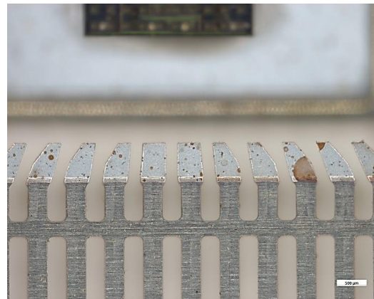
Abbildung 102: Mikroskopbild bei 32-facher Vergrößerung der Silberkontakte auf dem Leadframe nach dem Ar-Plasmareinigen
