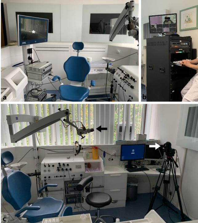
**Abb. 1** ◀ Untersuchungsraum mit technischer Ausstattung zur Übertragung. **a** Ansicht auf den Untersuchungsstuhl mit Endoskopie-System (Stern), **b** Übertragungseinheit, **c** seitliche Ansicht mit Mikroskop (schwarzer Pfeil) und der auf dem Stativ befindlichen Makrokamera („Saalkamera“, weißer Pfeil)
