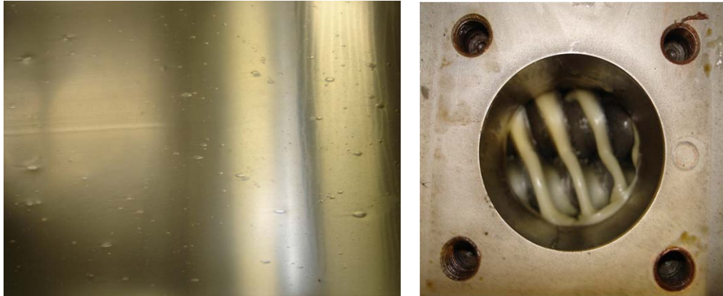
Abb. 5.8: Fehlstellen in Form von Gaseinschlüssen im extrudierten Folienband (links) und Entlüftungsöffnung in Zone 9 des Extruders zur Abführung volatiler Bestandteile (rechts)
