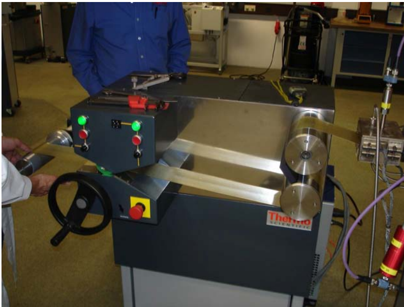
Abb. 4.6: Automatisiertes Folien- und Bandabzugssystem im laufenden Betrieb beim Abzug und Aufwickeln einer NaCas-Folie
