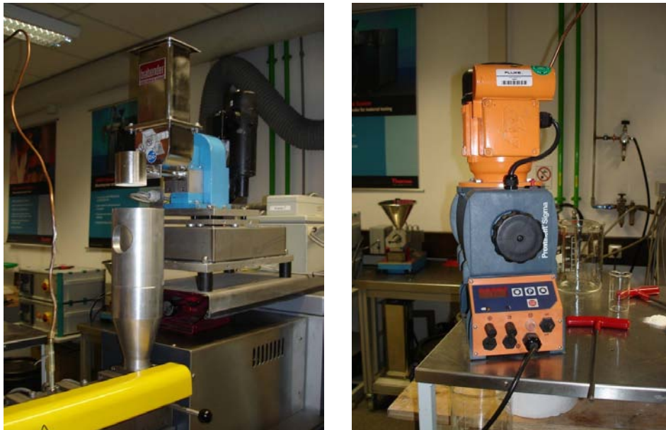
Abb. 4.4: Extruderzuführungssysteme bestehend aus einem gravimetrischen Feststofffeeder mit Trichterzuführung (links) und einer volumetrischen Flüssigkeitspumpe (rechts)
