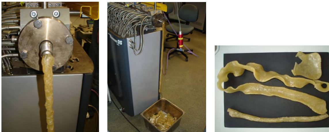
Abb. 5.15: Strangförmiges Extrudat als Ergebnis einer enzymatisch katalysierten Quervernetzungsreaktion mit MTG, 15 U/g NaCas (links und mittig) und Endprodukt in Strangform und sowie als Ergebnis einer post-extrudalen Walzprozesses (rechts)
