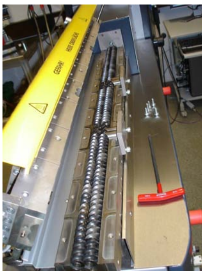
Abb. 4.3: Schneckenengeometrie des Extruders Haake PolyLab OS PTW 24/40 (links) mit Förderelementen (rechts oben) und Knetelementen (rechts unten) [Rau01a]
