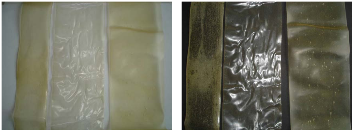
Abb. 5.7: Extrudierte NaCas-Folien bei unterschiedlichen Temperaturprofilen charakterisiert über die Temperatur in der Düse T_D , 90 °C (links) 70 °C (mittig), 50 °C (rechts), Unterscheidung (l, r) nur durch verschiedenfarbige Unterlagen
