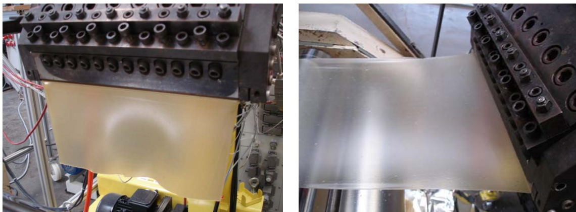
Abb. 5.4: NaCas-Folie als Ergebnis des Formgebungsprozesses des Extrudates (links) und Folienabzug mittels einer Edelstahlwalze als Kalandertestandteil (rechts)
