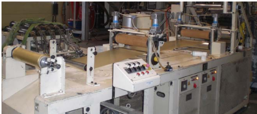
Abb. 4.12: Automatisiertes Film- und Bandabzugssystem mit 2-Walzenkalandar zum Folienabzug sowie Transport- und Aufwickelsystem
