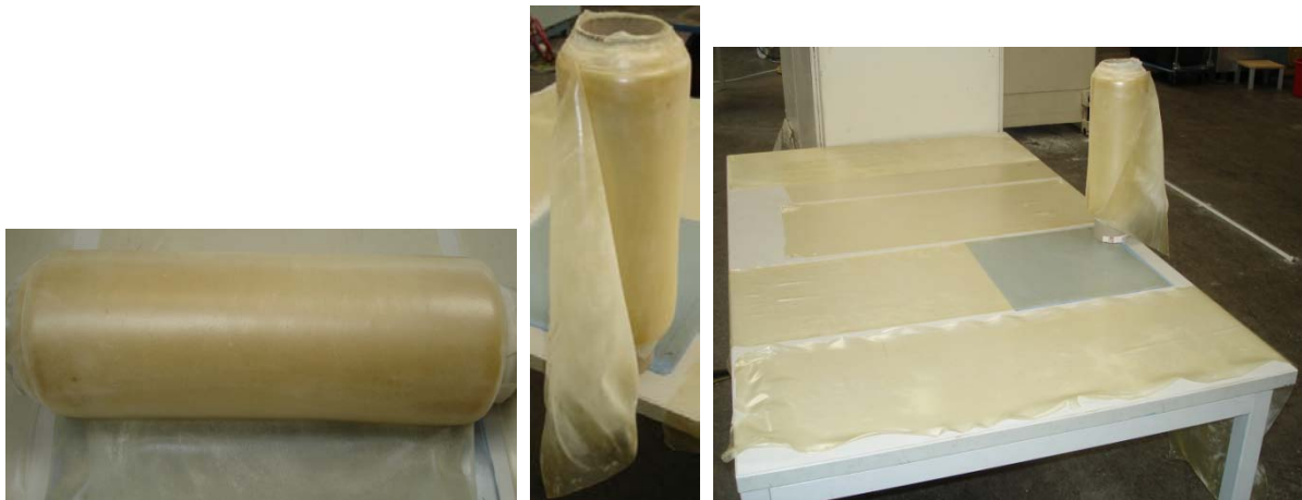
Abb. 5.9: Extrudierte NaCas-Folien einschließlich Weiterverarbeitung zu Folienrollen
