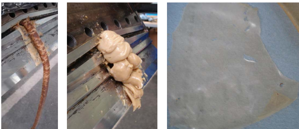
Abb. 5.6: Erbsenprotein-Extrudat in Strangform als Ergebnis der Versuche E01 bis E03 (links), Versuche E04 und E05 (mittig) und in gepresster Form aus den Versuchen E04 und E05 (rechts), Tab. 4.4
