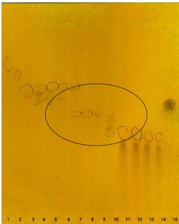
Abbildung 15 DC mit Fraktionen 1 – 14 der Kieselgel-Aufreinigung; eingekreist Fraktionen mit ähnlicher Polarität wie Matairesinol, auf Pos. 15 Matairesinolstandard
