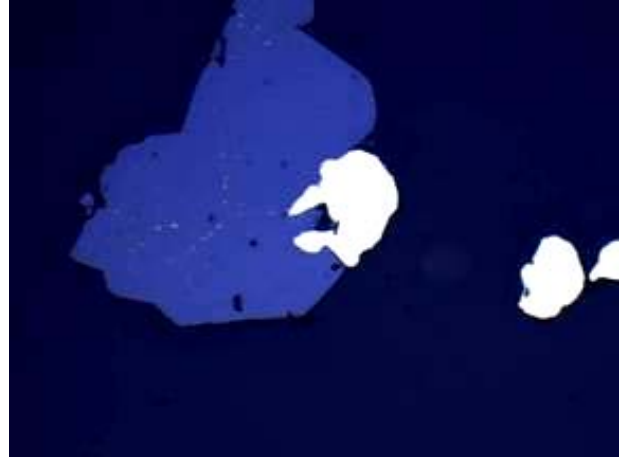
Abb. 24: Verwachsung von Sphalerit (dunkel) mit Chalkopyritentmischungen (helle Punkte) und Gold (weiß) in typischer polymetallischer Gold-Vererzungen (Cavnic). Auflicht, 10x
