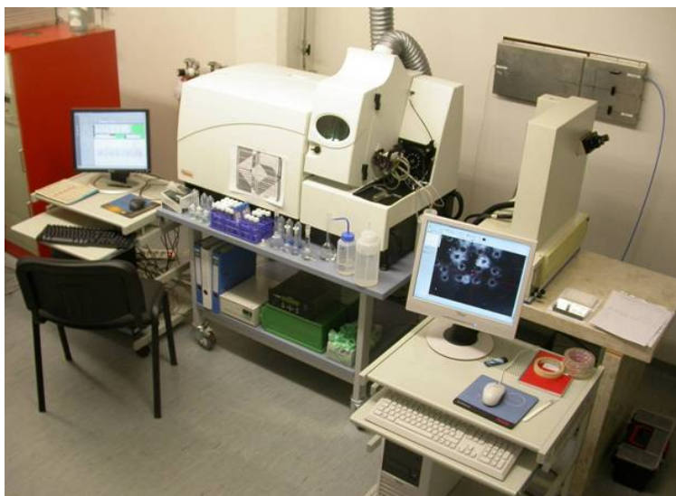
Abb. 38: Aufbau der LA-QICP-MS am CEZ-Archäometrie in Mannheim. Rechts die Lasereinheit und der zugehörige Steuerungscomputer, links das ICP-MS mit dem Probeneinlass und dem Plasma auf der rechten Seite. Der Nebulizer ist über einen Mischer direkt vor dem Plasma in das System eingebunden.
