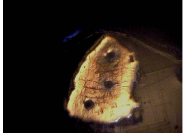
Abb. 49 und Abb. 50: Ablationsschmauch auf der Probe bei Ablation mit Argon (links) und Helium (rechts)
