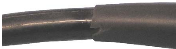
Abbildung 18: Materialermüdung des OLYMPUS ® -Endoskop Nr. 1 nach ca. 180 STERRAD ® -Zyklen
