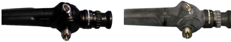
Abbildung 17: OLYMPUS ® -Endoskop CYF-5A im Originalzustand und Materialveränderungen nach ca. 150 STERRAD ® -Zyklen
