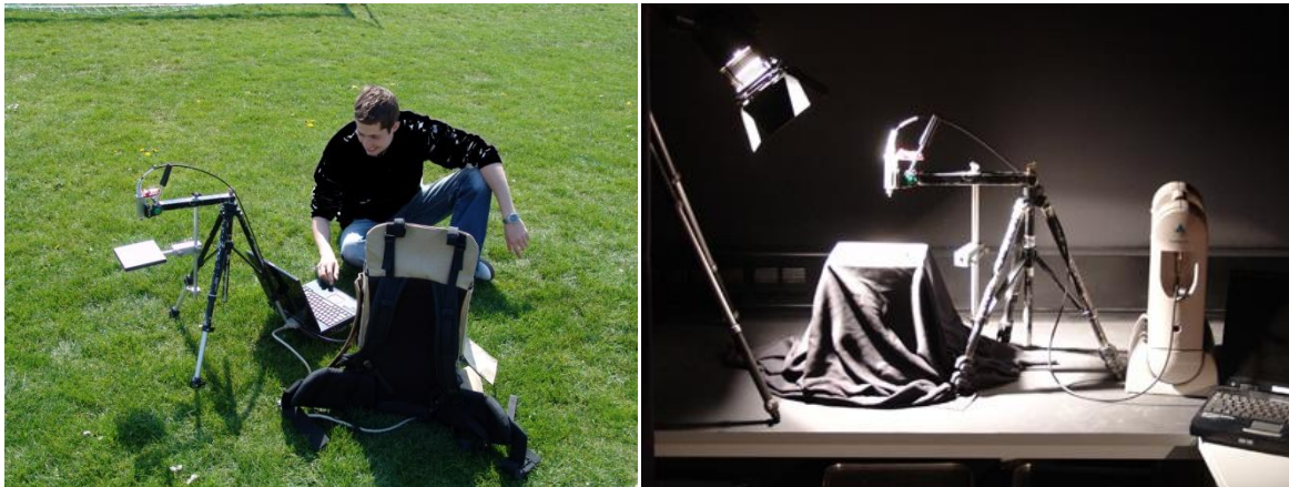
Abbildung 3.4: Feldspektrometrische Messungen vom 21.06.08 (links) und Aufbau der spektrometrischen Labormessungen (rechts).
