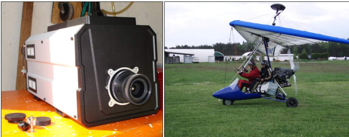
Abbildung 3.7: AISA Eagle Hyperspektralsensor (links) und Ultraleichtflugzeug (Trike) (links).
