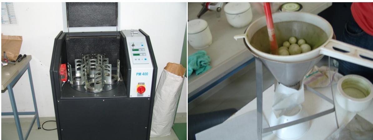
Abbildung 3.2: Foto von der Planeten-Kugelmühle (links) und Foto von der Abfüllung des gemahlten Pflanzenmaterials (rechts).
