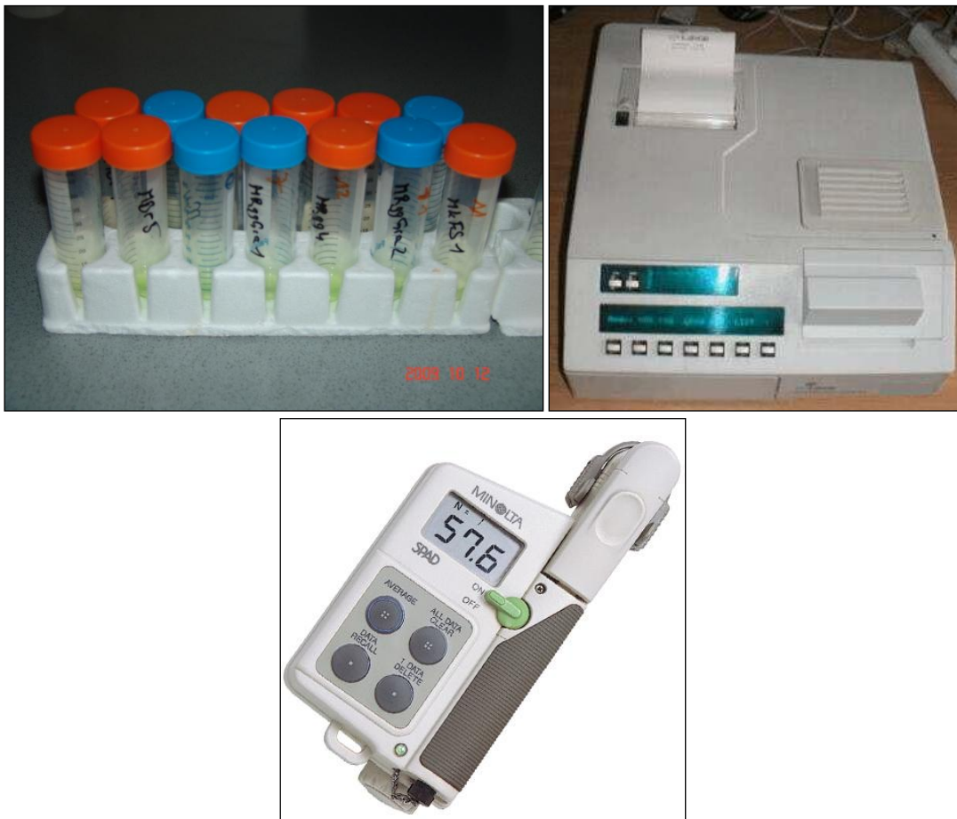
Abbildung 3.3: Extrahierte Pigmentlösung aus den untersuchten Pflanzen (oben links), Spektralphotometer (oben rechts) und Chlorophyllgehaltsmessgerät SPAD-502 ( www.envcoglobal.com ) (unten).
