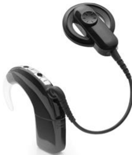
Abbildung 2: Aufbau eines Cochlea-Implantats mit Nucleus ® 6 Soundprozessor (HdO-Gerät, Hersteller: Cochlear Ltd.)
