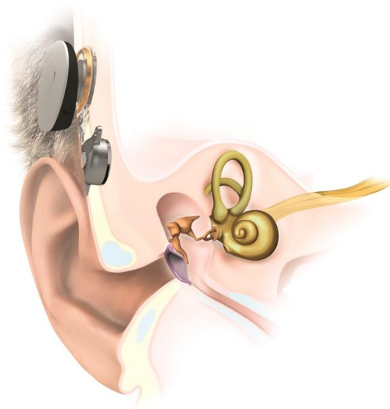
Abbildung 1: BCI 602-Implantat mit dem außen aufsitzenden Single-Unit-Prozessor SAMBA (Hersteller: MED-EL Elektromedizinische Geräte Deutschland GmbH)
