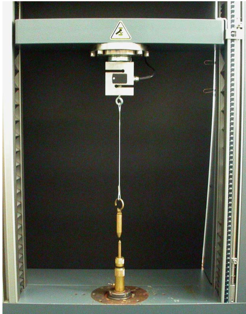
Abb. 5 Versuchsaufbau in der Zwick Testmaschine
