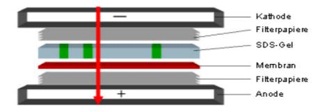
**Abb.1** Schematische Zeichnung eines Western Blot Aufbaus
