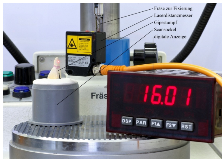
Abbildung 15: Laserdistanzmesser (Fa. Welotec, Laer) fertig zum Messen
