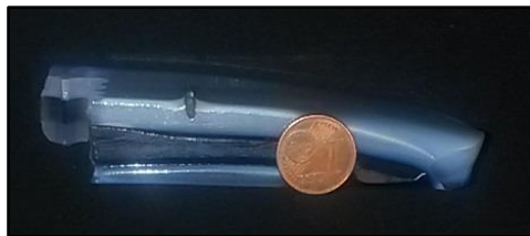
Abbildung 4.113: Bild eines hergestellten, laminierten Glasmonolithen (hier nach Formgebung I) aus (v. u. n. o.) Glas Nr. 5, Nr. 34 und Nr. 29.
