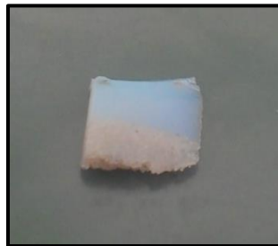
Abbildung 4.29: Bild von entmischem 8/26/66-Glas (Nr. 8).
