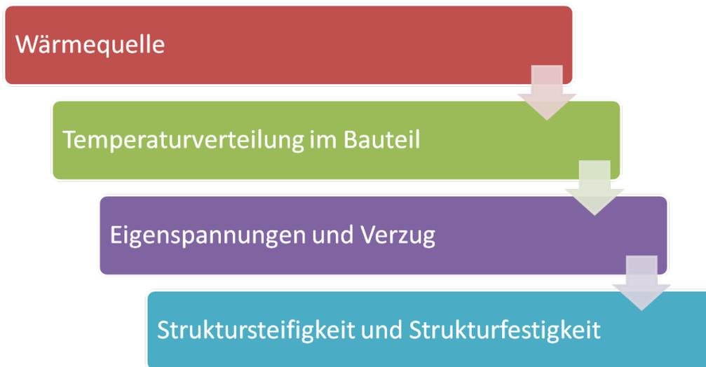
**Abbildung 4.2:** Vorgehensweise zur strukturelle-mechanischen Untersuchung einer Struktur mit Schweißverbindung
