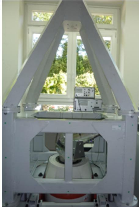
**Abbildung 5.5:** Versuchsaufbau zur experimentellen Modal-Analyse am  $45^\circ$ -Ausschnitt aus einem Konus, Sicht1
