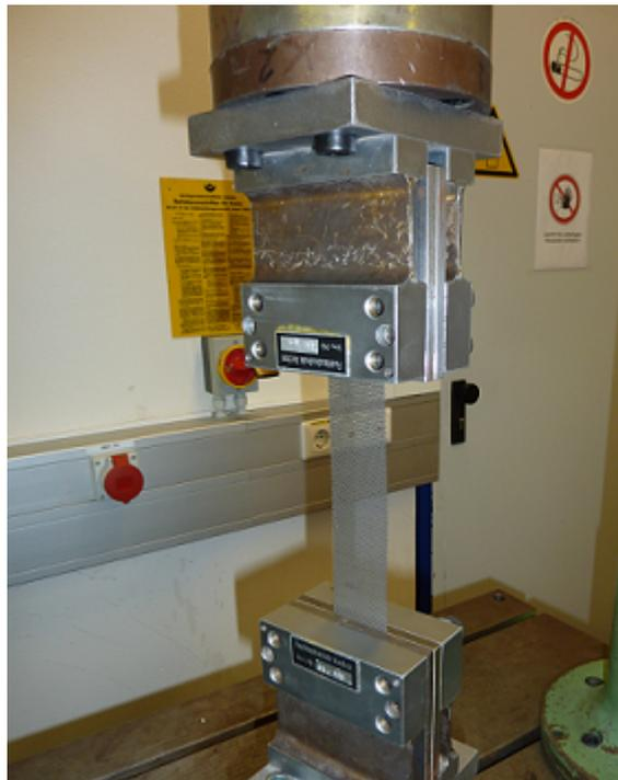
**Abbildung 3.15:** Versuchsaufbau des Zugversuch an einer Lochblechprobe
