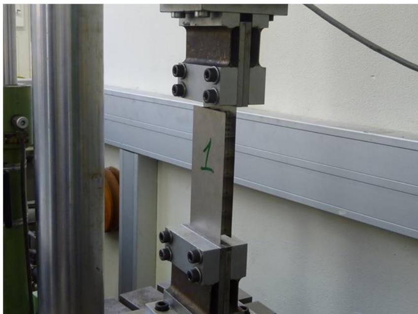
**Abbildung 4.9:** Aufbau des Scherzugversuchs
