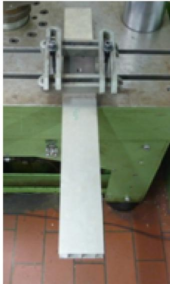
**Abbildung 5.1:** Ebene Struktur einseitig eingespannt, Sicht von oben
