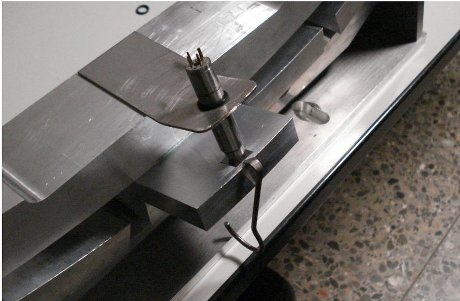
**Abbildung 5.8:** Versuchsaufbau zur Ermittlung der Biegesteifigkeit der Einspannvorrichtung mit einem eingebauten Wegsensor und einem Haken zur Aufnahme der Last
