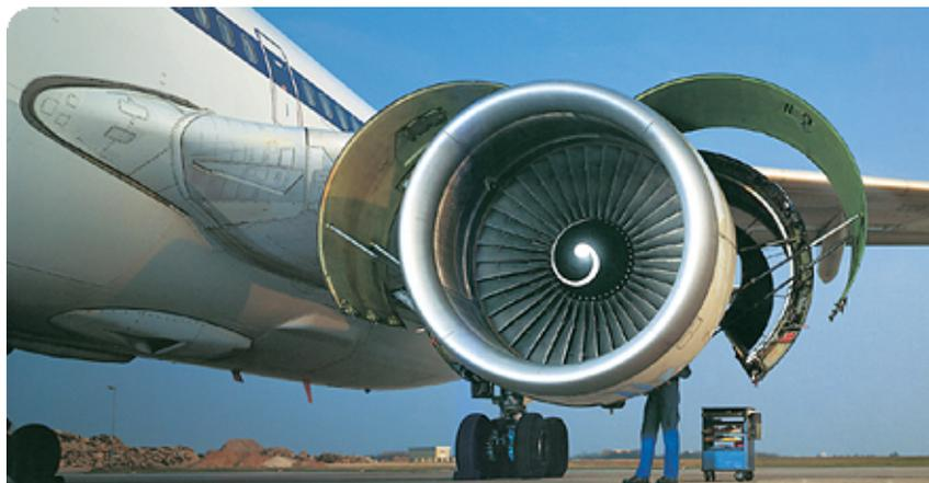
**Abbildung 1.2:** Triebwerksverkleidung eines CF6-Antriebes nach [10]
