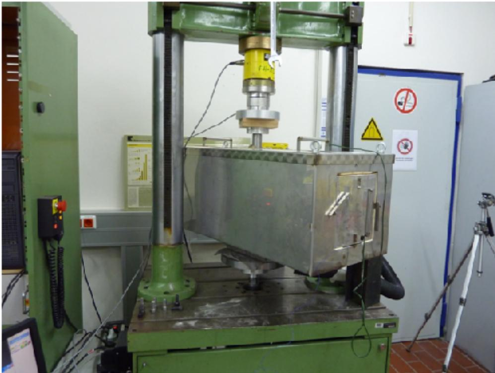
Abbildung 3.12: Versuchsaufbau 3-Punktbiegung unter Temperatur
