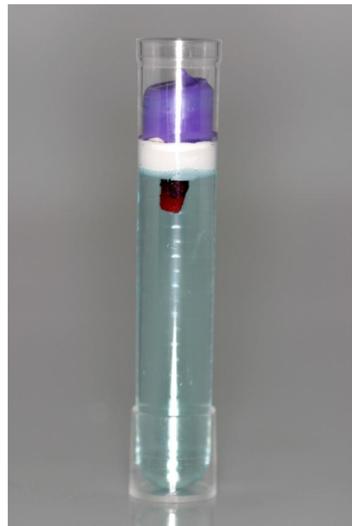
Abb. 9: Darstellung einer Probe mit diffundiertem Methylenblau
