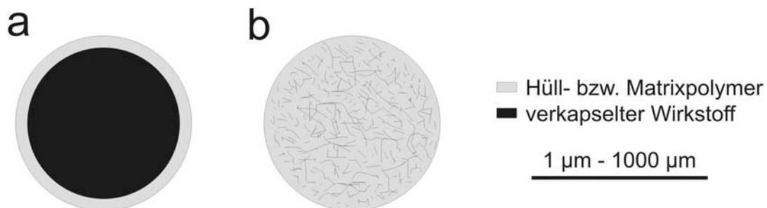
**Abbildung 2.3-1** Schematische Darstellung von a) einer Kern-Hülle-Mikrokapsel und b) einem Matrix-Mikropartikel (modifiziert nach <sup>64</sup>)
