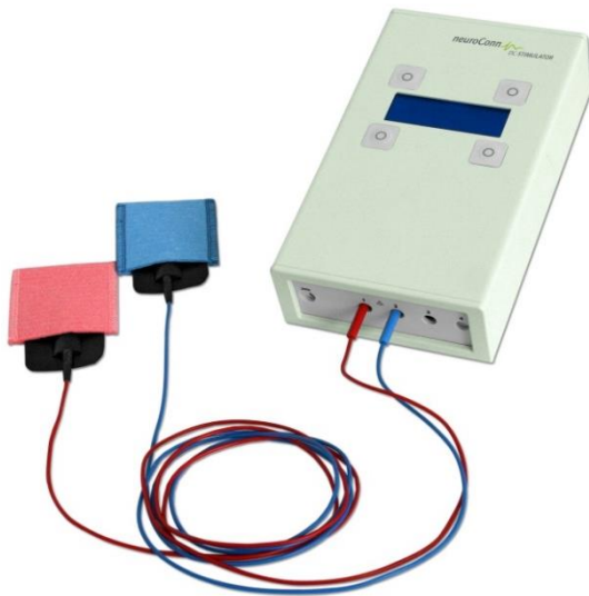
Abbildung 6: DC-Stimulator Plus, Schwammelektroden und Verbindungskabel zur Applikation von transkranieller Random Noise Stimulation (tRNS). (Quelle: https://www.neurocaregroup.com/dc_stimulator_plus.html , 21.10.2019)
