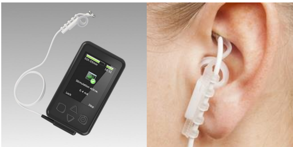
Abbildung 5: Transkutane Vagusnervstimulator mit Generatoreinheit, verbindendem Kabel und bipolarer Ohreinheit (links) und Platzierung letzterer in der Cymba conchae des linken Ohres (rechts). (Quelle: https://www.nemos.uk.com , 21.10.2019)
