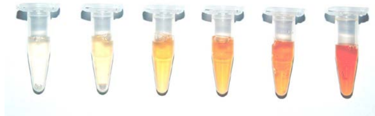
Abbildung 8: Kalibrationsreihe der Thiozyanatbestimmung (deutlich erkennbar der Eisen(III)-Thiozyanatkomplex)
