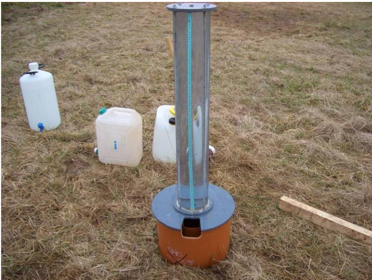
**Abb. 3.32:** Aufbau des Doppelring-Infiltrometers 100m westlich der Messstelle B6.
