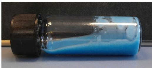
**Abbildung 8:** Emulsionsgel bestehend aus 50 % Dextranblaulösung und 50 % Lipogel auf Basis von MCT mit 4 % Cithrol<sup>TM</sup> DPHS und 3 % 12-Hydroxystearinsäure.
