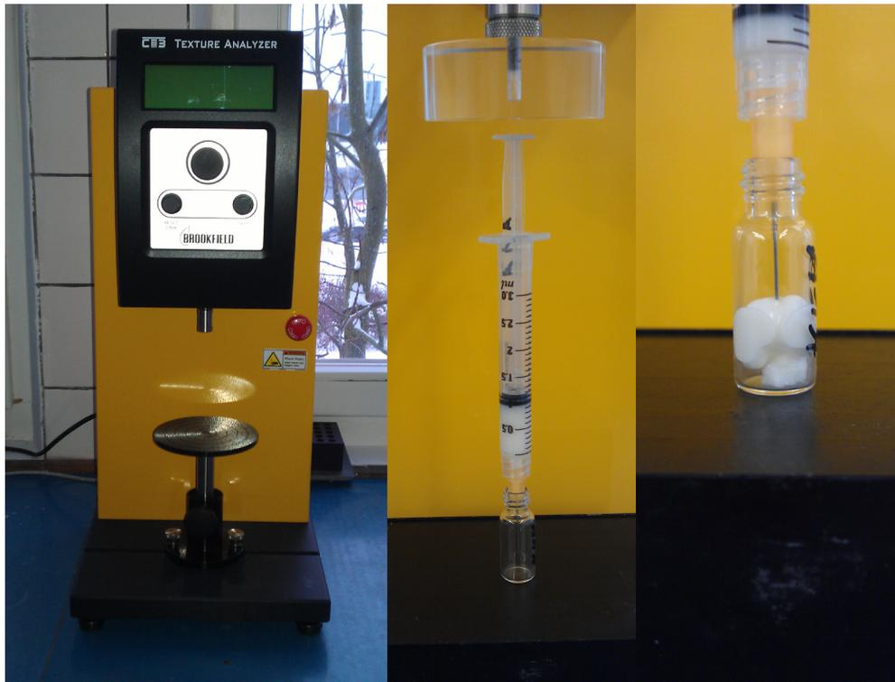
**Abbildung 49:** CT3-4500 TextureAnalyzer von Brookfield/Rheotec Ottendorf-Okrilla, Deutschland (links); Versuchsaufbau zur Injektionskraftbestimmung (Mitte); dabei ausgespritztes Gel (rechts).
