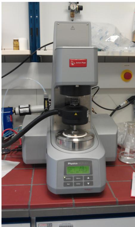
**Abbildung 48:** *Physica MCR 301 Oszillationsrheometer von Anton Paar mit Kegel-Platte-Geometrie; Durchmesser: 24,982 mm; Winkel des Kegels: 1,003°; Messspalt: 48  $\mu\text{m}$ .*
