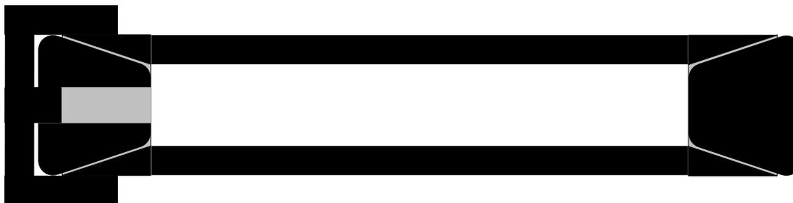
**Abbildung 35:** *Erster Entwurf eines neuen Freisetzungmodells (nicht umgesetzt). Ein Dialyseschlauch sollte durch ein äußeres Gerüst gehalten und das Ende mittels eines Schraubverschlusses verschließbar sein.*
