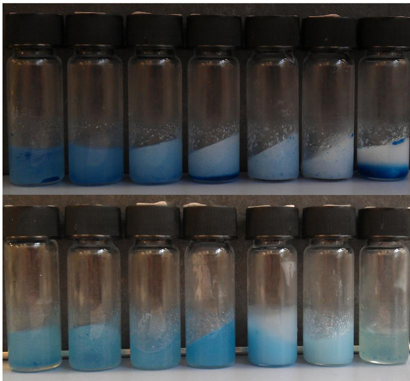
**Abbildung 6:** *Emulsionsgele mit MCT und Erdnussöl und verschiedenen 12-Hydroxystearinsäurekonzentrationen. Oben: Mittelkettige Triglyceride, unten: Erdnussöl. Von links nach rechts: 2 %, 2,5 %, 3 %, 3,5 %, 4 %, 5 %, 6 % 12-Hydroxystearinsäure.*
