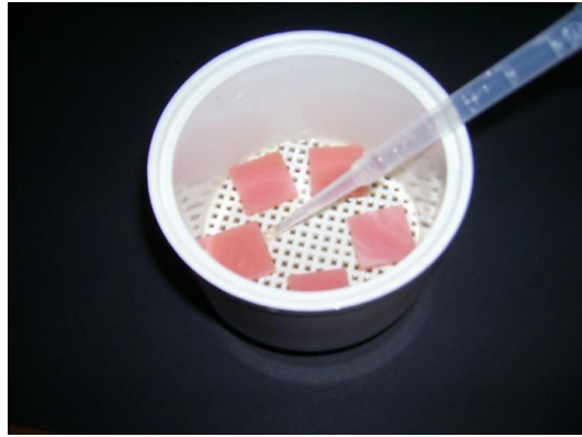
Abb. 15: Benetzung der PK mit Mucalgin® während der Einwirkzeit mittels Serumpipette
