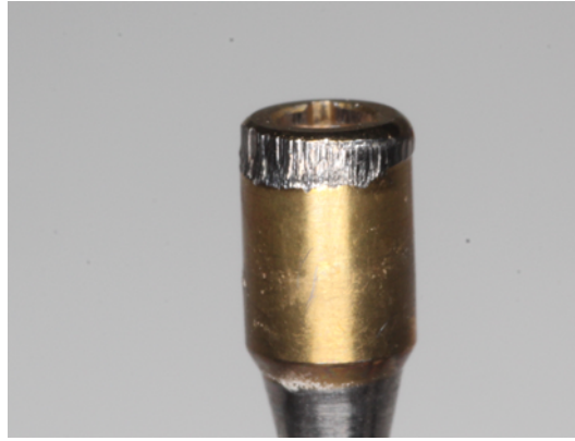
Abbildung 6: Foto einer abgenutzten Locator-Patrize mit Titannitrid-Beschichtung
