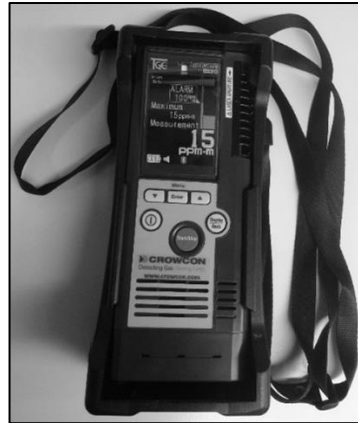
Abbildung 4: Laser-Methan-Detektor (Tokyo Gas Engineering Solutions, Tokyo, Japan) (Bild: S.Mühlbach)
