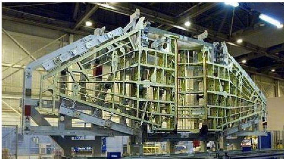
Abbildung 5-8 Typische Tragflächenstruktur kleiner und mittlerer Flugzeuge
