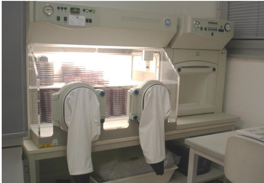
**Abbildung 5:** Anaerobierbank (Modular Atmosphere Controlled System, MG500, Meintrup dws, Löhden-Holte, Deutschland)
