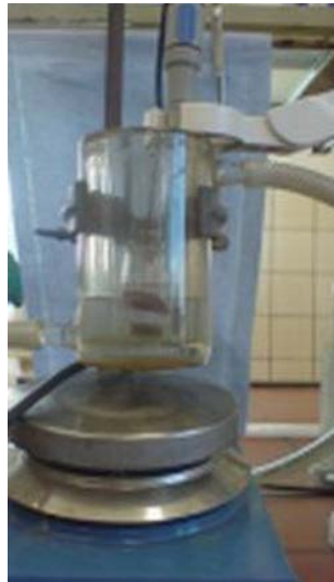
Abb. 3.15 Messapparatur zur Bestimmung der Enzymaktivität Foto: Technische Chemie, Martin-Luther-Universität Halle-Wittenberg
