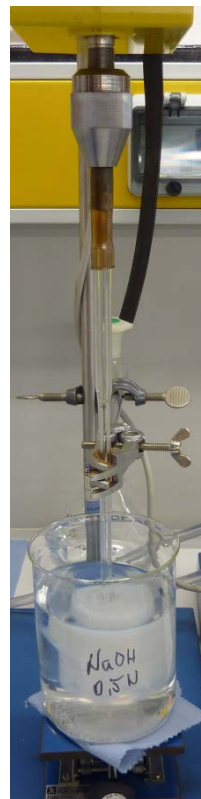
Abb. 3.9 Anlage zur alkalischen Nachbehandlung
