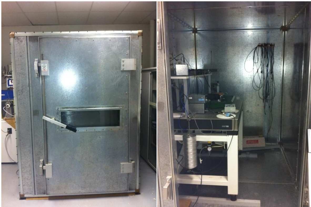
Abbildung 5.1 Abschirmkammer für Rauschmessungen mit einer Höhe von ca. 2 m im Departement für Physik an der École Normale Supérieure in Lyon (ENS de Lyon)
