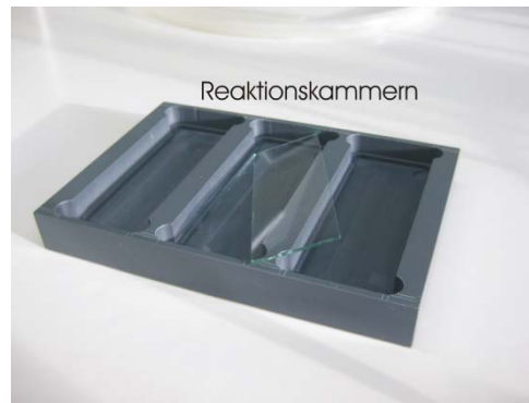
Abb. 2-2 Inkubationskammer für Glasobjektträger mit drei Reaktionskammern. Der Boden wurde passgenau für klassische Objektträger (76 mm x 26 mm) ausgefräst.
