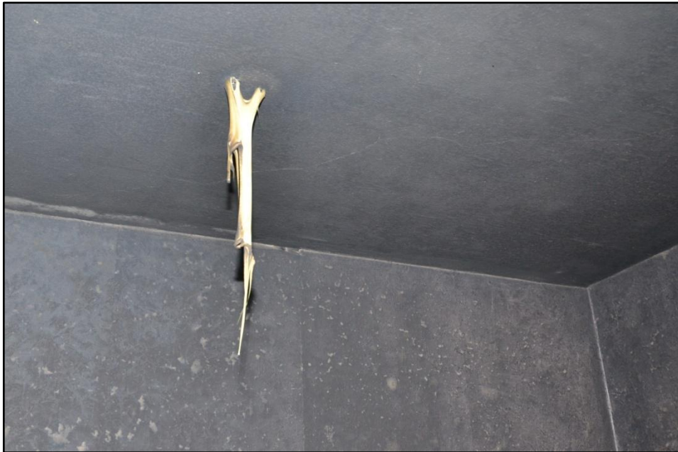
Abbildung 29: Geschmolzener Brandmelder nach Wohnungsbrand, S 283/14
