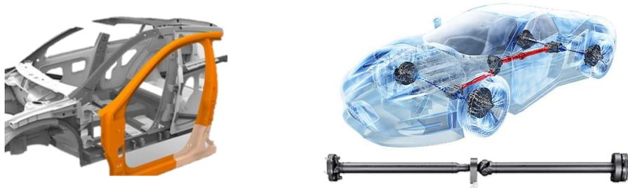
*Abbildung 1-1: Beispielhafte Blech-Hohlprofilverbindungen im Automobilsektor – Ausschnitt einer Karosseriestruktur (links) [17]; Längswelle im Automobil (rechts) [18]*
