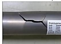
Abbildung 8-2: Wöhlerkurve der jeweiligen Applikationsverfahren (einseitiges Widerstandslöten vs. einseitiges Widerstandsschweißen) inkl. exemplarischer Schliff- und Versagensbilder
