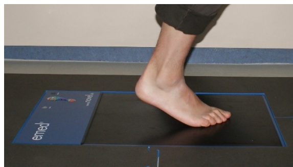
Abbildung 8: Gangbahn mit Messplatte Quelle: eigenes Archiv
