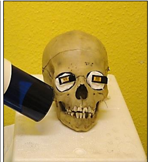
Abbildung 13 Kinderschädel mit Photo-Chipstratedosimetern an Position der Augenlinsen bei der Aufnahme des Oberkiefer Seitenzahns in Regio 16 mit dem Heliodont von Sirona
