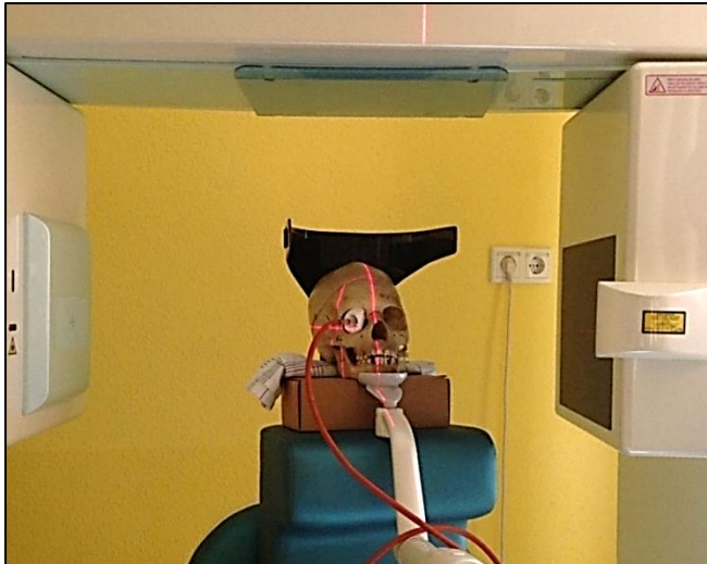
Abbildung 12 Versuchsaufbau mit Kinderschädel und PTW- Unidos im 3D Accuitomo XYZ Slice View von Morita, Einstellung für eine Bildgebung des rechten Kiefergelenks, Positionierung anhand von Laservisieren, Befestigung des Dosimeters in rechter Orbita zur Messung der Linsendosis
