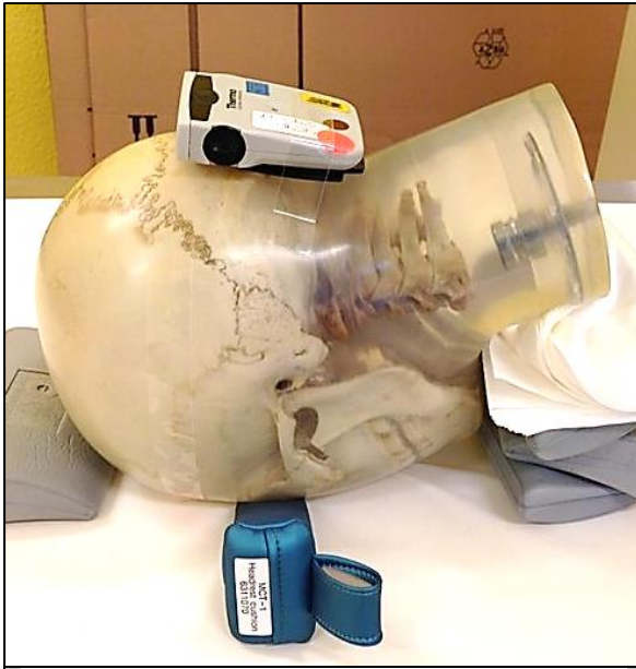
Abbildung 8 Versuchsaufbau mit Modellschädel und EPD im Multix Swing, Positionierung für eine Schädelaufnahme nach Clementsitsch mit dem Betafenster des Dosimeters im Zentralstrahl
