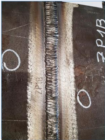
Abb. 6: Übersichtsdarstellung der Probe ZP1B, Decklage in PE und zugehörigem Makroschliff
