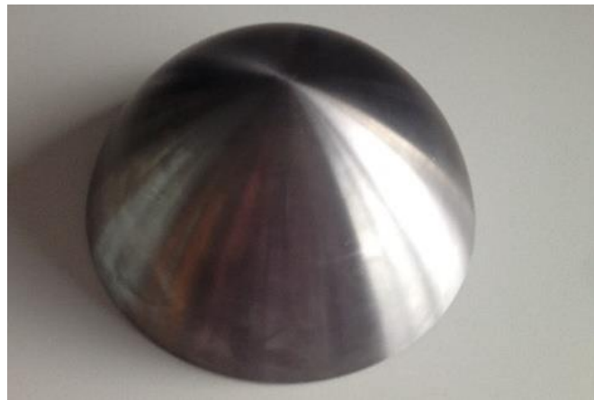
Abb. 4: WEBAM Halbschale aus Tantal, mechanisch bearbeitet (Mit freundlicher Genehmigung von Nuclear AMRC)
