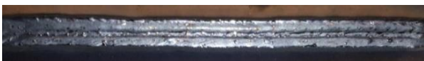
Abb. 3: Eine 3-lagige Kehlnaht, geschweißt mit einem G 4Si1 Ø1,2 mm, Schutzgas M21-ArC-18, zeigt ein hohes Aufkommen an Oxiden/Silikaten auf der Oberfläche, schwer entfernbar
