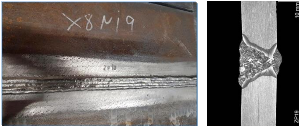
Abb. 4: Übersichtsdarstellung der Probe ZP19, Decklage in PC und zugehörigem Makroschliff
