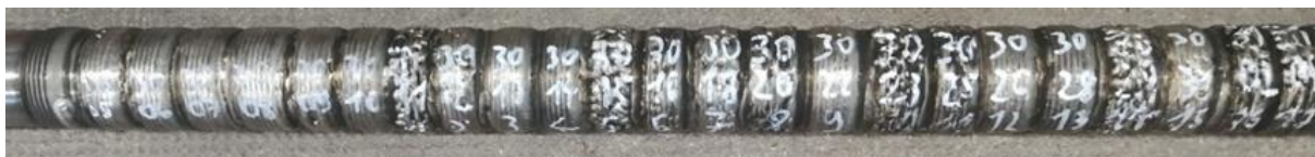
Abb. 6: Komplett abgeschweißter Versuchsplan auf 2 m langem Rohrstück mit 24 plattierten Segmenten
