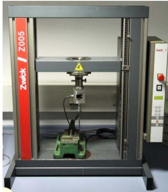
Abb. 23: Prüfmaschine Zwick Z005
