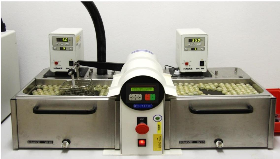
Abb. 22: Thermozyklriergerät
