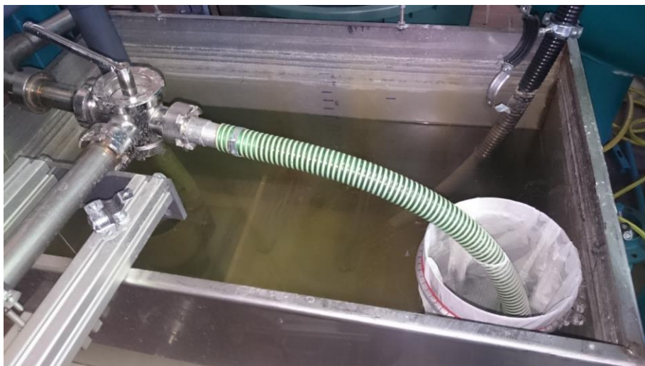
Abb. B-33: Filtergaze im Pufferbecken zur Filterung des Kokillenausflusses
