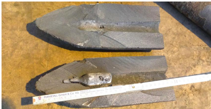
Abb. B-44: Ablagerungen nach einem Injektionsversuch mit Blei am realen Prozess
