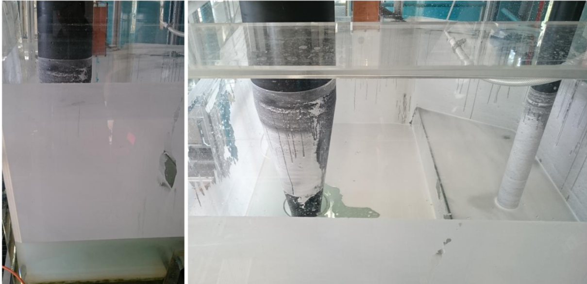
Abb. B-36: Kontaminierter Verteiler mit Hohlglaskugeln S32
