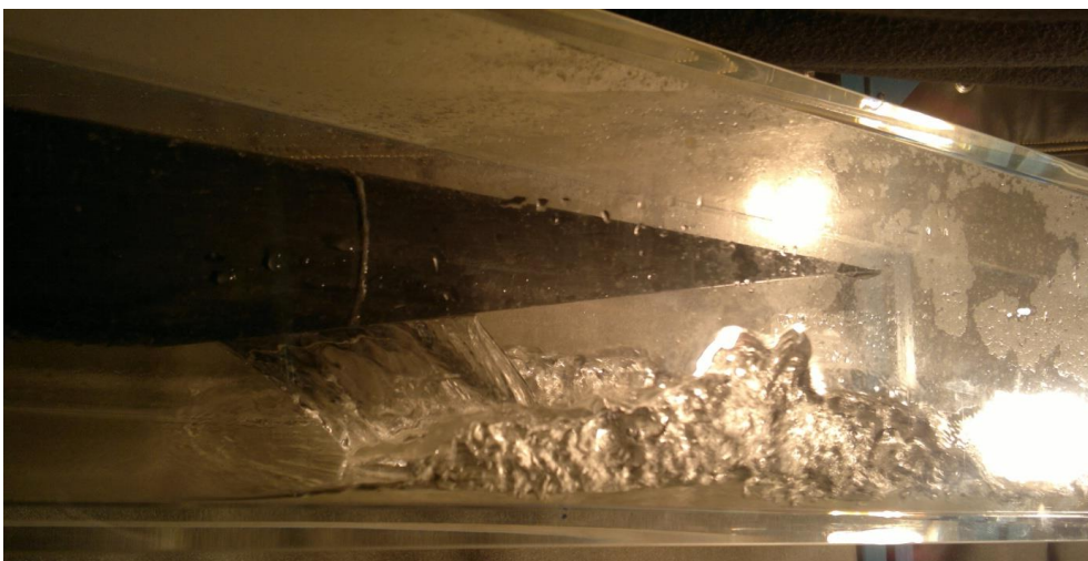
Abb. C-9: Abriss der vollausbildeten Rohrströmung beim Tauchrohr mit 12° Gärung
