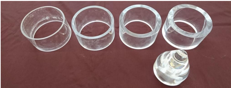
Abb. B-53: Variation des Kragendurchmesser 150, 140, 130 und 120 mm mit einer gemeinsamen Höhe von 90 mm
