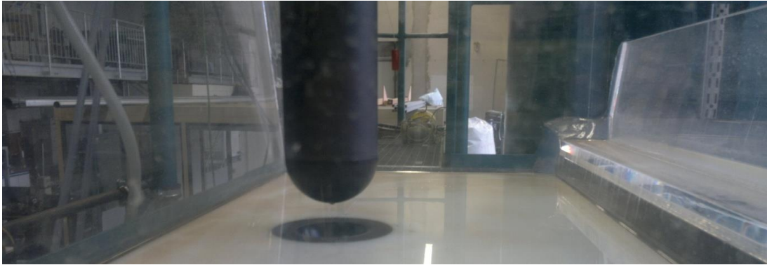
Abb. C-36: Verbesserte Stopfenspitze für das Verfahren der Bandgießanlage
