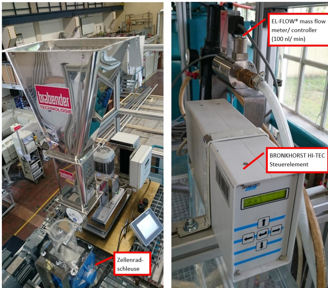
Abb. A-25: Förderschnecke mit Bedienelement und zylindrischen Aufbau zur Feinstaubminimierung beim Übergang von Förderschnecke auf die Zellenradschleuse (links) und Druckluftregelung/ -messung (rechts)
