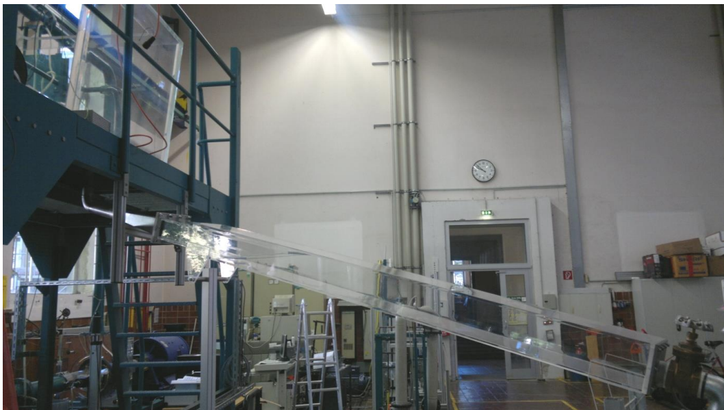
Abb. A-15: Optisch zugängliche Modellierung der Bandgießanlage
