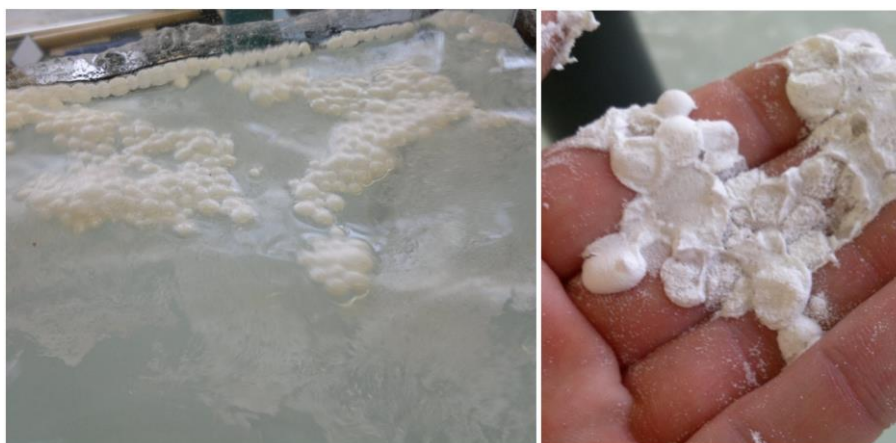
Abb. B-6: Agglomerierte Partikel mit Lufteinschluss an der Oberfläche des Badspiegels im Verteiler (links) und Trockene Partikel innerhalb eines geplatzten Pulver-Agglomerats (rechts)
