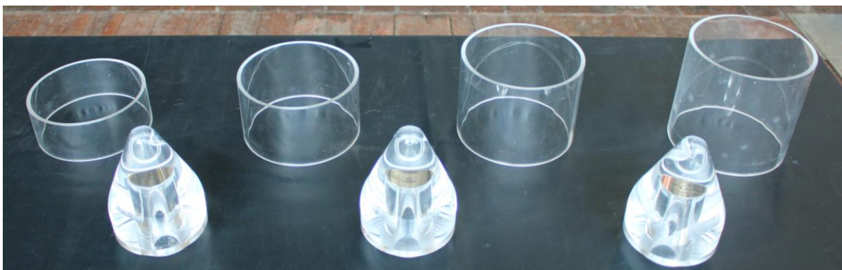
Abb. B-45: Vier Varianten der Kragenhöhe (6, 9, 12 und 15 cm) und drei Variationen an Stopfenspitzen mit unterschiedlichen Bohrungsdurchmessern (5, 8 und 12 mm)
