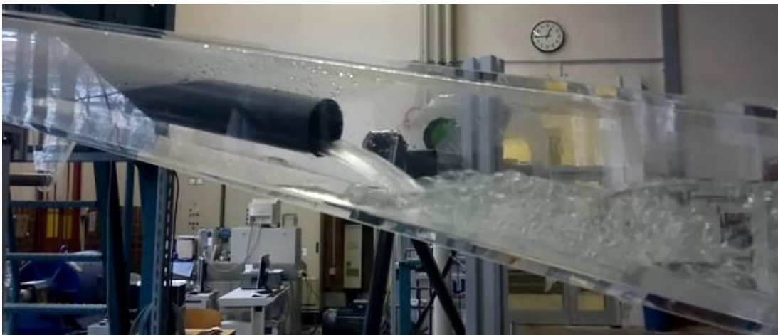
Abb. C-37: Filmströmung im Tauchrohr bei geringem Massenstrom
