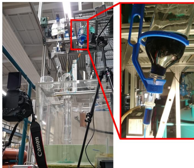
Abb. B-48: Dosiervorrichtung für den Tracer-Farbstoff und Position der Kamera zur Ermittlung der Geschwindigkeit
