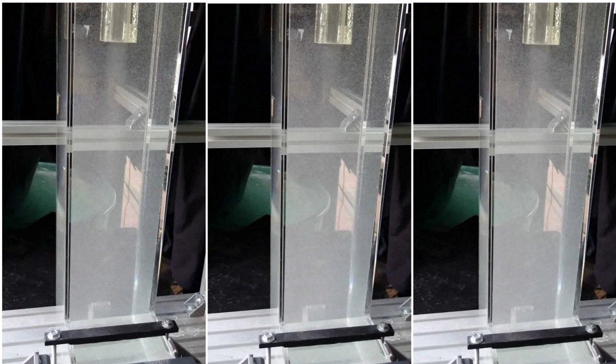
Abb. B-31: PVC-Partikelinjektion 6kg/h mit verbessertem Stopfen ohne Kragen (zeitlicher Abstand der Aufnahmen: 0,5s von links nach rechts)
