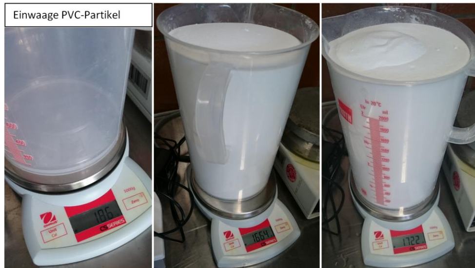
Abb. B-34: Einwaage der PVC-Partikel, leerer Becher (links), Injektion mit Kragen (Mitte), Injektion ohne Kragen (rechts)
