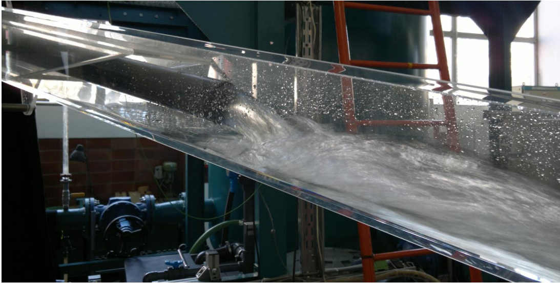
Abb. C-38: Vollausbildete Rohrströmung im Tauchrohr
