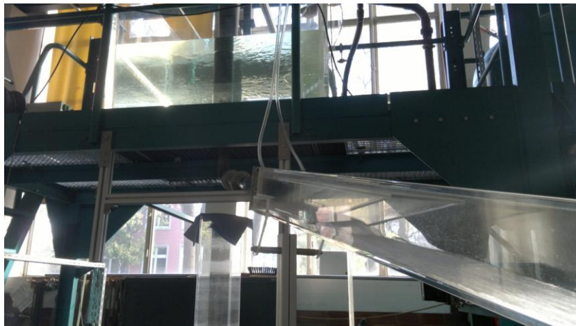
Abb. C-2: Filmströmung beim Tauchrohr mit rechteckigem Querschnitt
