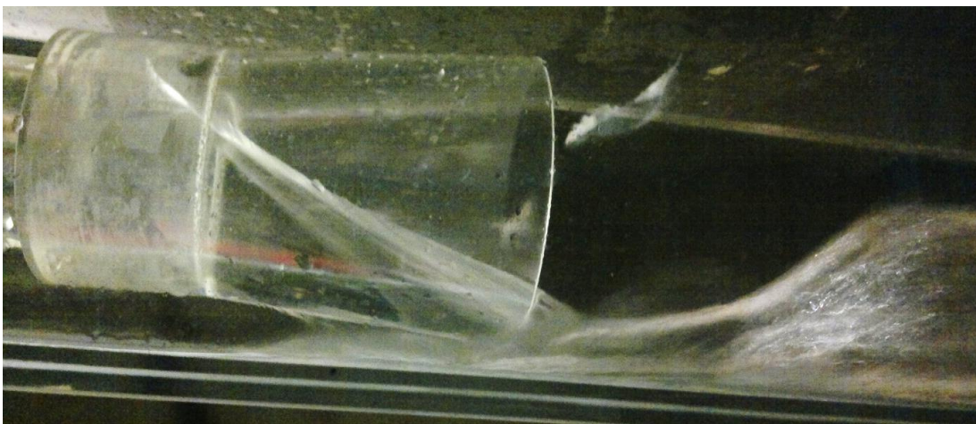
Abb. C-39: Abriss der vollausbildeten Rohrströmung bei Querschnittserweiterung
