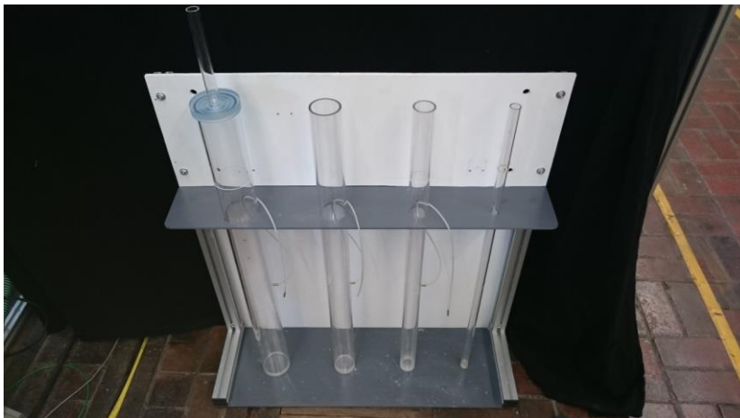
Abb. B-12: Versuchsstand "Blasensäulen-Set" mit 4 Rohren und Deckel
