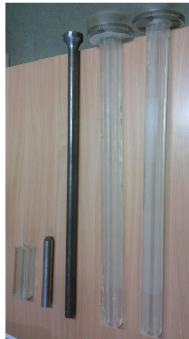
Abb. A-16: Konstruktionszeichnung des originalen Tauchrohres (links) und vom IFF gefertigte Tauchrohre aus Epoxidharz und Negativform des Strömungsraumes (rechts)
