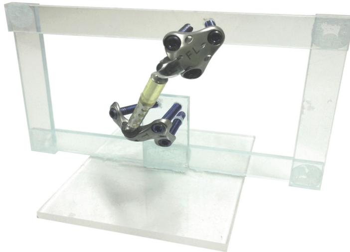
Abb. 3: Fixierung des Atlas Knee System® auf einem Plexiglasrahmen für die Positionierung in dem Zylinderphantom [21]
