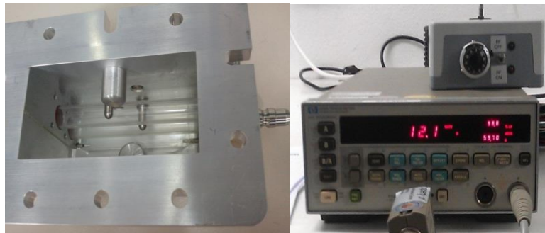
Abb. 17: Innenansicht der Glasrohrlast (links), Schaltnetzteil (rechts)
