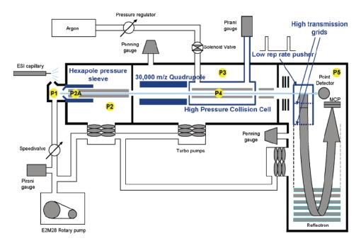
Abb. 1.8: Schematische Darstellung des modifizierten High-Mass Q TOF II-Massenspektrometers. Die vorgenommenen Modifikationen für die Analyse sehr großer Ionen sind blau hervorgehoben. (Q-TOF II der Firma Waters/Micromass modifiziert durch MSVision, Abbildung entnommen aus [125].)
