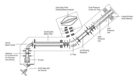
Abb. 1.7: Schematische Darstellung des Orbitrap Fusion Tribrid-Massenspektrometers. (Thermo Fisher Scientific, www.planetorbitrap.com/orbitrap-fusion. Abbildung nach [124]).
