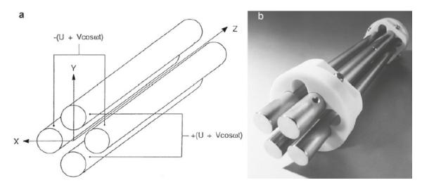
Abb. 1.6: Detailansicht eines Quadrupol-Massenfilters. a) Schematische Darstellung des Quadrupols mit eingezeichneten Achsen; Spannungen (U = Gleichspannung, V = Wechselspannung). b) Detailansicht eines Quadrupols (Abbildungen entnommen aus [102]).
