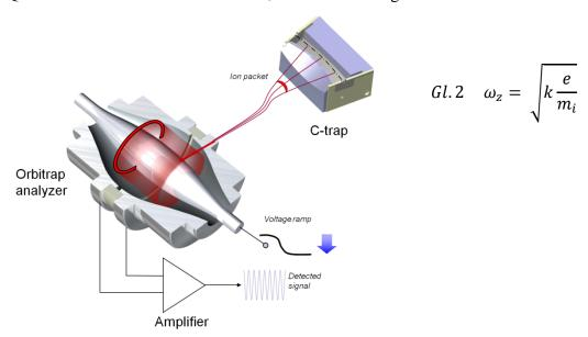
Abb. 1.5: Querschnitt einer C-Trap und einer Orbitrap. Links: Es wird der Detektionsprozess während eines Spannungsgradienten gezeigt (Abbildung entnommen aus [122]). Rechts: Gleichung zur Berechnung der axialen Oszillationsfrequenz in der Orbitrap.
