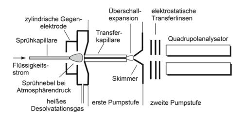
Abb. 1.4: Aufbau einer ESI-Quelle. Schematischer Aufbau einer ESI-Quelle. Die Analytlösung wird mittels einer Kapillare zum Eingang des Massenspektrometers geführt. Durch das Anlegen einer elektrischen Spannung entsteht ein Spray, das zur Desolvatisierung der Ionen und deren Eintritt ins Massenspektrometer führt. Abbildung nach [102].
