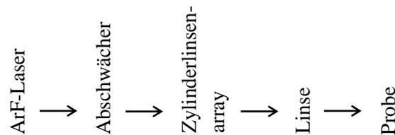
**Abb. 3.1:** Aufbau zur Bestrahlung von großflächigen, unstrukturierten Bereichen auf der Probe
