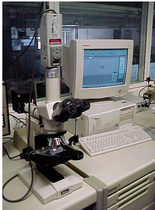
Abb. 6: Arbeitsplatz mit Auflichtmikroskop, digitaler Kamera und angeschlossenem Computer
