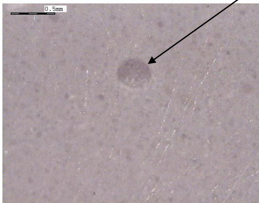
Abb. 24: esthetic-base ® 300 Gipsstruktur des Proben-Innenschliffs unter Standardbedingungen Maßstab 1:28
