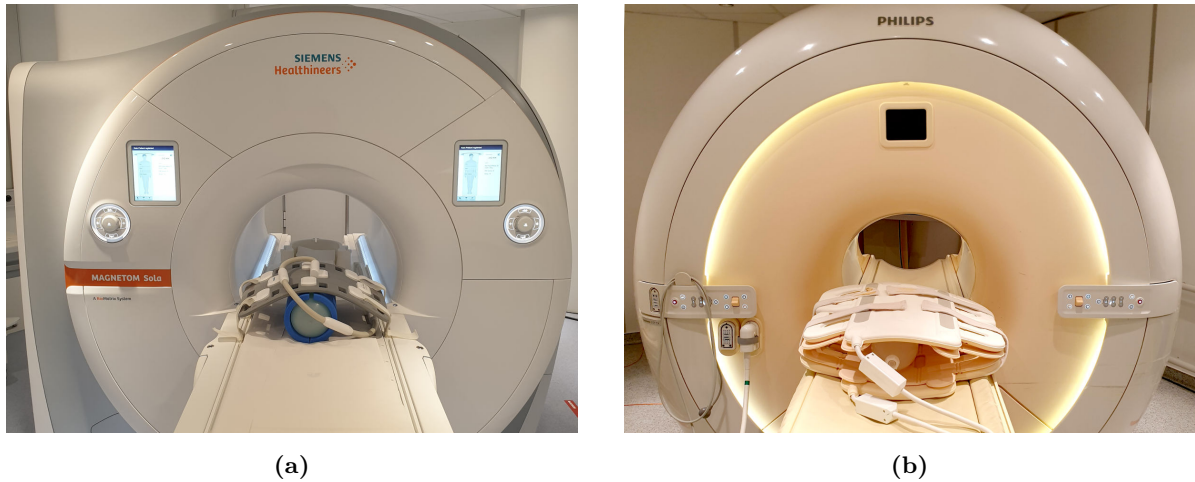
Bild 7: Fotos der verwendeten MRTs mit zylindrischem Phantom in der HF-Körperspule. (a) Siemens MAGNETOM Sola 1,5 T mit Body-18-Spule (weitere Spulen in den Tisch integriert). (b) Philips Achieva 3 T mit Torso-XL-Spule (16 Kanäle).
