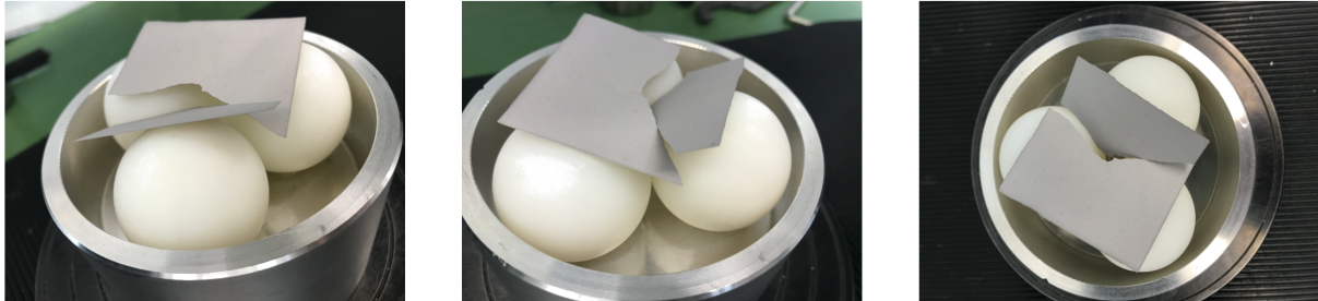
Bruchverhalten der Druckschichten aus verschiedenen Perspektiven.
