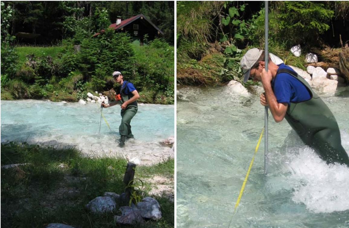
Abb. 3.3. Abflussmessung (links) und Geschiebemessung mittels Helley-Smith-Sammler (rechts) an der Messstation „Bockhütte“ am 18. Juli 2005 bei  $Q = 3,9 \text{ m}^3\text{s}^{-1}$  (Fotos Olaf Klammer)
