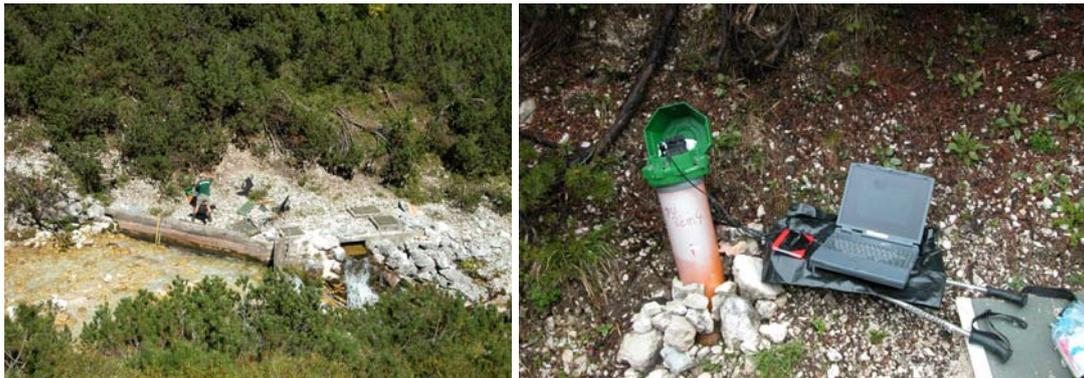
Abb. 3.2. Überblick Messstation „Partnach-Ursprung“ mit Messsteg am Einlass zur Rohrleitung für das Turbinenhäuschen der „Reintalangerhütte“ (links) (Foto Markus Witzsche 5. September 2003), Auslesen der Loggereinheit Orpheus-K (rechts) (Foto David Morche 6. Juni 2006)
